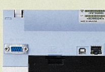
標準インターフェースとしてUSB、LAN、RS-232Cを搭載。
